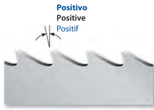
Geometría del filo de corte trapezoidal Trapezoid Cutting Blade Geometry Géométrie du filet de coupe trapézoïdal
