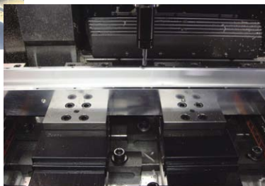
▲浮上りを極小に抑えて安定した加工精度 ▲Minimum lift-up ensures stable machining accuracy.
